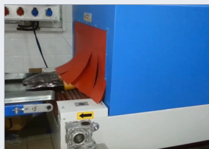
Tunel KT2 - výstupní dopravník
