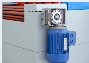
Tunel KT2 - motor dopravníku
