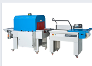
Balicí stroj + smršťovací tunel
