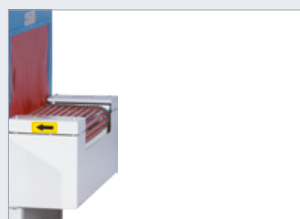
Vstup do tunelu s válečkovým dopr.
