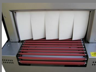
Poteflonované příčky v tunelu
