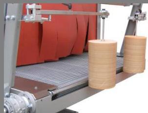
Výstup z balicího stroje
