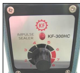
nastavení času sváření potenciometrem
