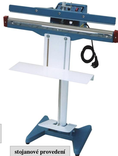
nastavení času sváření potenciometrem
